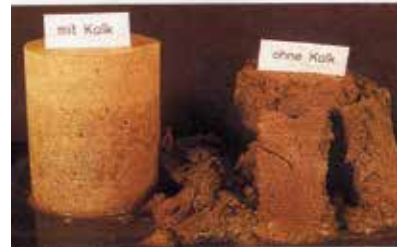
Bodenstruktur-Stabilisierung mit Branntkalk
