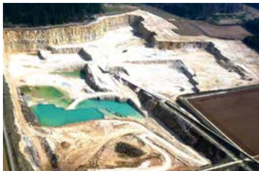
Terrassenabbau durch Absprengung von Kalkstein
