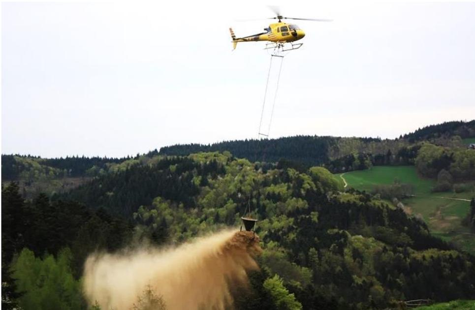
**Abbildung 2.3-3: Aviotechnische Kalkausbringung mit dem Hubschrauber. Foto: Helix Fluggesellschaft mbH.**
