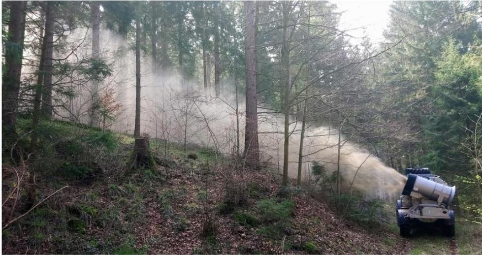
Abbildung 2.3-1: Terrestrische Kalkausbringung mit dem Unimog. Foto: FVA.
