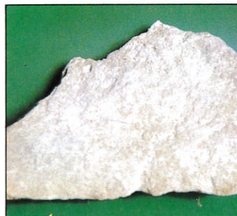
Bei Einfluß von Feuchtigkeit setzt sich der Branntkalk unter starker Wärmeentwicklung sekundenschnell um
